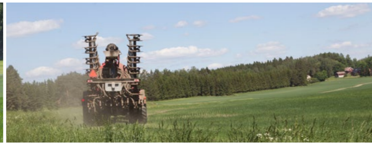
Lietteen siirrossa pumppukuormaimilla varustetut säiliörekka ja levitysvaunu vaativat siirrettävän välivarastokontin ympärille kunnollisen tien. Sijoittava kiekkomultain vähentää ympäristöhaittoja (alhaalla vasemmalla). Levityskalusto tarvitsee siirtoajossa tilaa myös yläpuolella.
