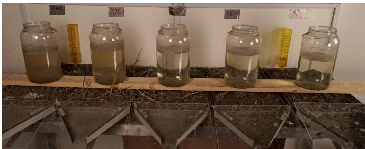
Vesinäytteet 24 viikon jälkeen (maaliskuussa 2019). Vasemmalla kyntönäytteessä veden fosforipitoisuus oli korkein. Kipsin ja rakennekalkin teho fosforin pidättämisessä oli todettavissa positiivisena tekijänä. Oikealta lukien rakennekalkki, kipsi, Rikkiviisas, suorakylvö ja kyntö (Kuva: Jussi Knaapi).
