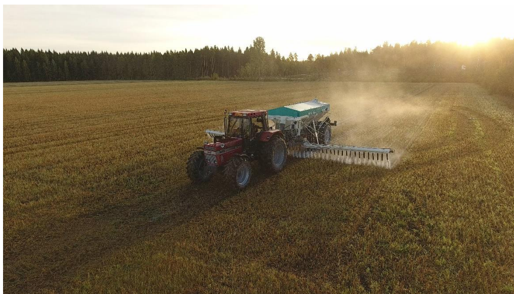
Rakennekalkin levitys koekentällä syksyllä 2018 (Kuva: Jussi Knaapi)
